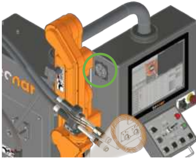
Fan monitor right
